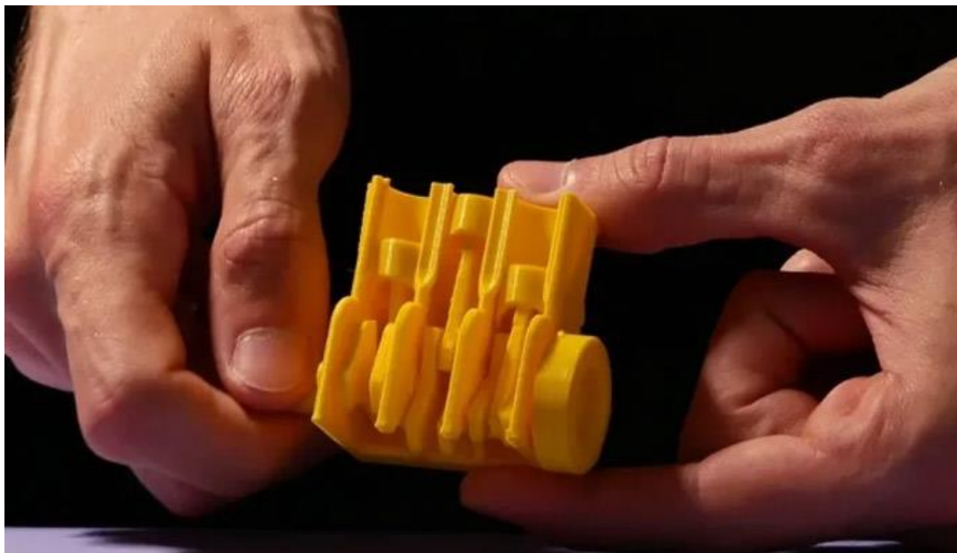
Εικόνα 21: Τομή ενός τρικύλινδρου εμβολοφόρου κινητήρα σε μινιατούρα με κινούμενα μέρη, εκτυπωμένου σε 3D, πηγή (Mélanie, 2020)
