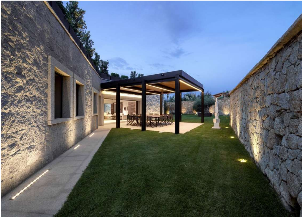
Εικόνα 11: Παράδειγμα up lighting , πηγή : (Iguzzini, 2016-2022)
