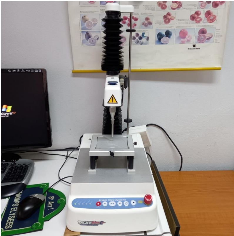
Εικόνα 21. Αναλυτής υφής Texture Analyser - TA.XT.Plus.
