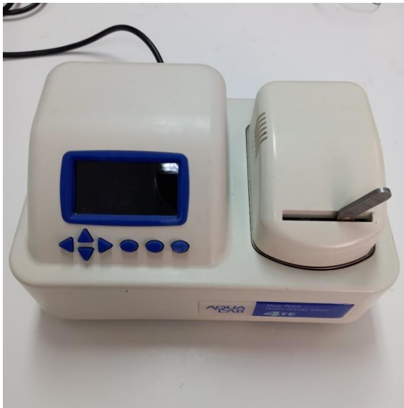
Εικόνα 16. AquaLab Dew Point Water Activity Meter 4TE.
