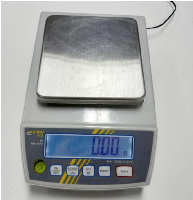
Εικόνα 14. Ζυγός εργαστηρίου (Precision balance PCB, Kern).
