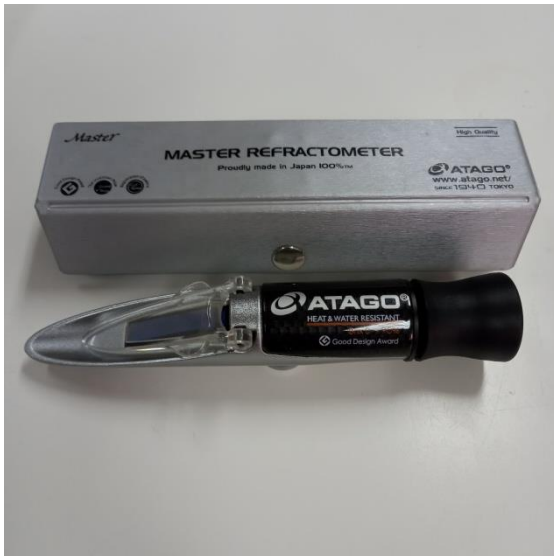
Εικόνα 17. Διαθλασίμετρο χειρός 0-90% (ATAGO).
