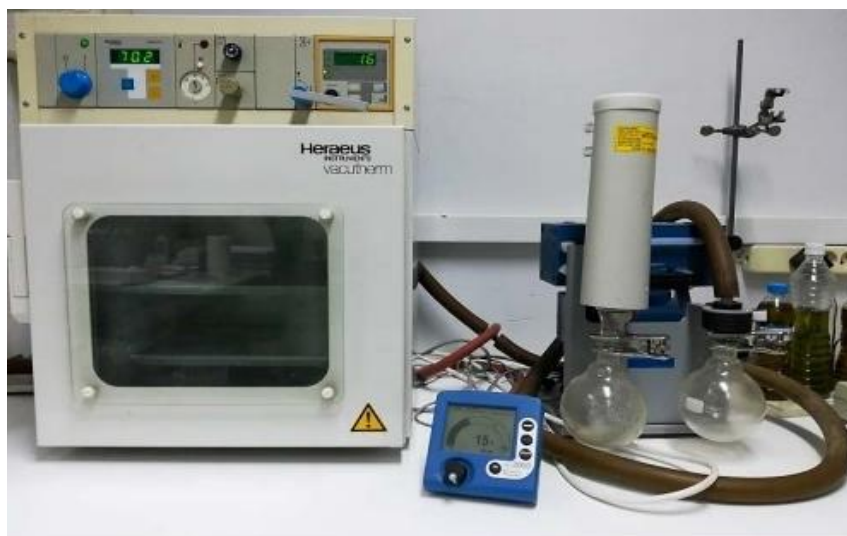
Εικόνα 23. Φούρνος κενού ( Heraeus Instruments VT 602).
