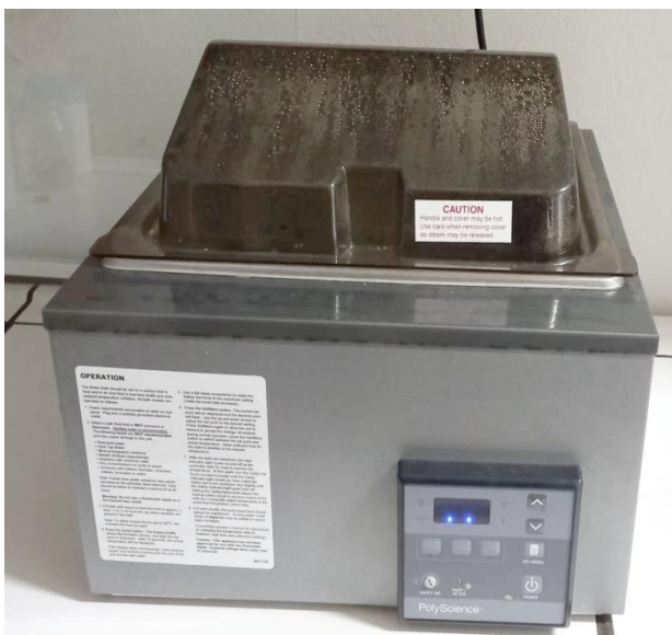
Εικόνα 15. Υδατόλουτρο εργαστηρίου (PolyScience water bath, WB10A11B).
