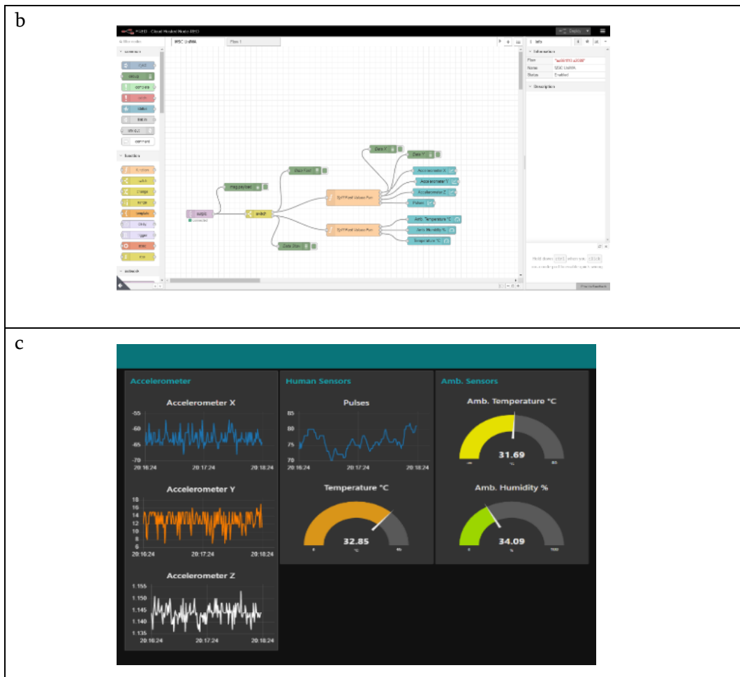
Σχήμα 26: a) MQTT cloud b) Nodes connection from FRED c) απεικόνιση σε πραγματικό χρόνο των μετρήσεων του φορετού συστήματος
