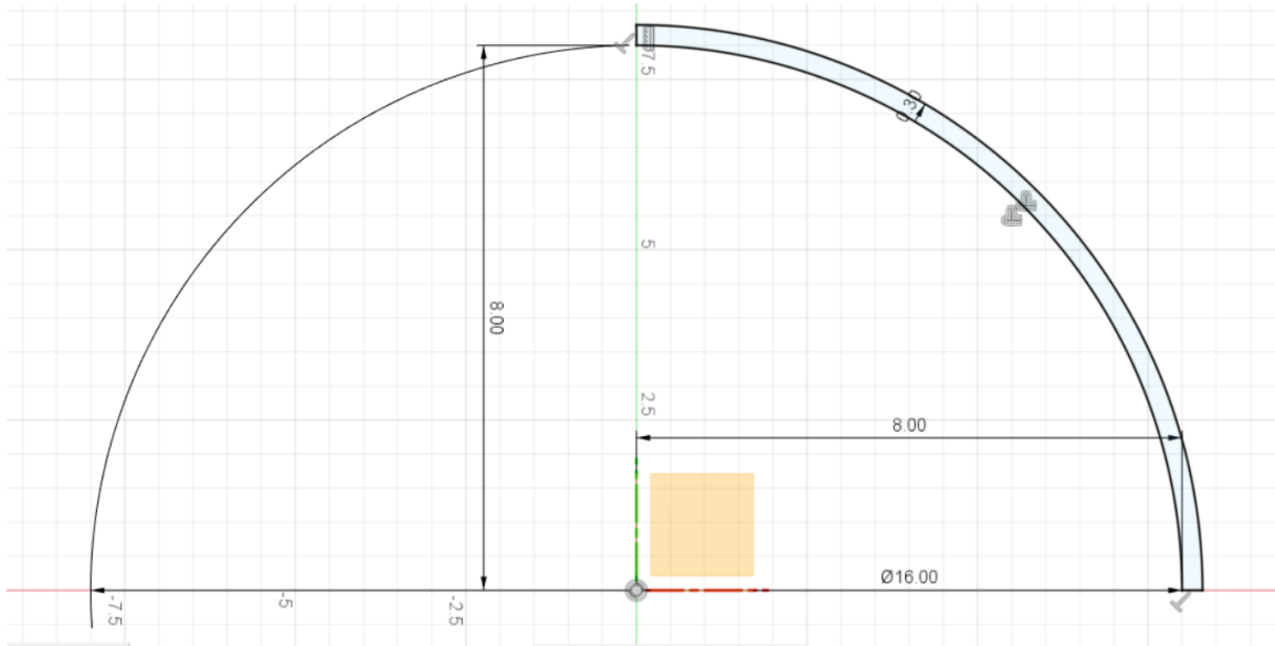
Εικόνα 12: Καθορισμός διαστάσεων του κελύφους
