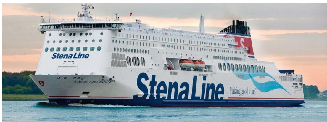
Εικόνα 6: Πλοίο Ro-Pax χωρητικότητας 63.600 κόρων (Stena Hollandica) (Roussou, 2015, p. 3)
