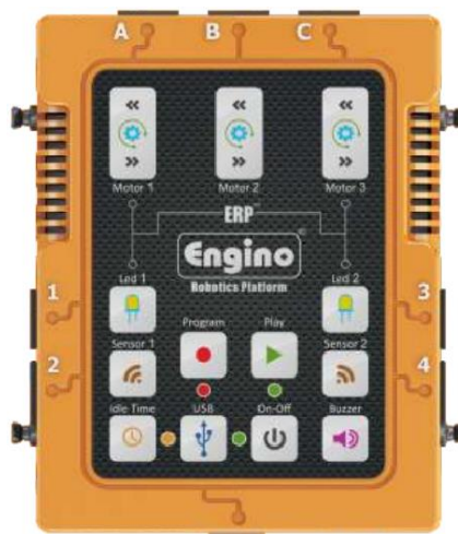
Εικόνα 67: Ο ERP ελεγκτής της Engino® [180].
