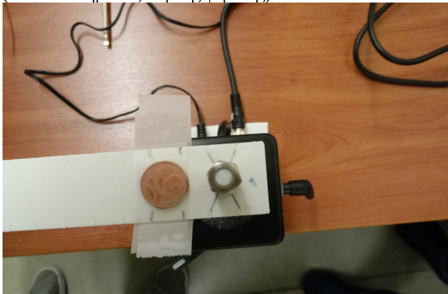
Σχήμα 4.3.2: Εξομοίωση δομικού ελαττώματος Πειράματος 1 με κέρμα ενός λεπτού κολλημένο στην επιφάνεια της δοκού στη θέση A (κοντά στο σημείο εξωτερικής φόρτισης).
