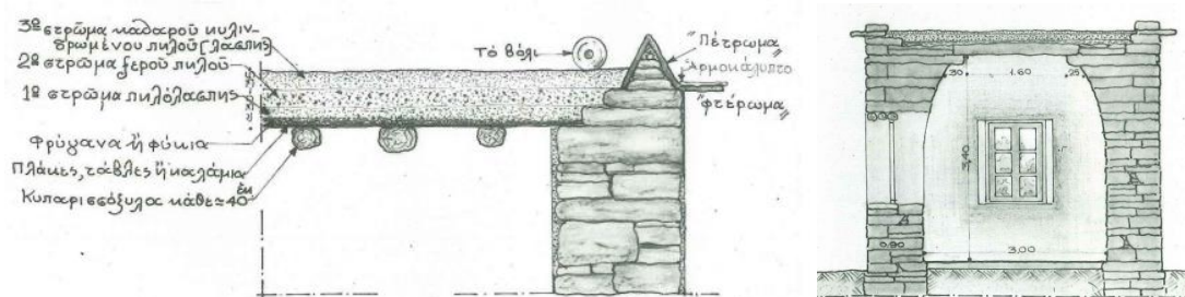
Σχέδιο 12 : Άνδρος : αριστερά: τυπική κατασκευή δώματος και δεξιά : εκφορικό σύστημα, πηγή : (Λυγίζος, Παλιά Αντρώτικα Σπίτια, 1983, σ. 325)
