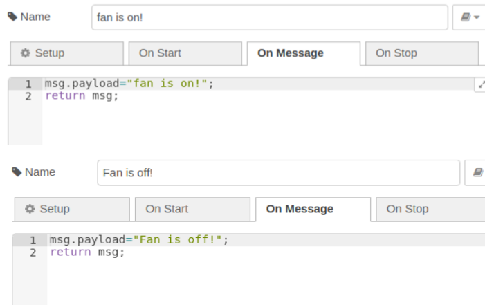
Εικόνα 3.112 - Μηνύματα ενεργοποίησης/απενεργοποίησης ανεμιστήρα στο function node.
