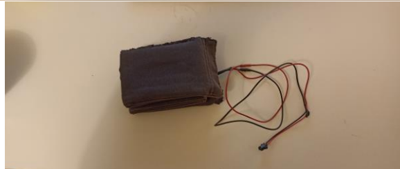
Εικόνα 3.127 - Ενσωμάτωση του φωτοβολταϊκού συστήματος, πάνω στο κομμάτι υφάσματος.
