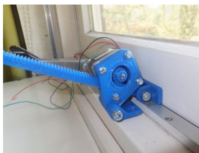
Εικόνα 5.28 - Αυτόματος μηχανισμός ανοίγματος παραθύρου. (BrightProjects, 2016)
