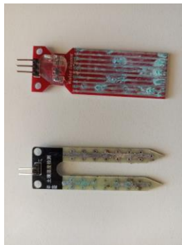
Εικόνα 5.20 - Οξείδωση αισθητήρα υγρασίας χώματος και στάθμης νερού.
