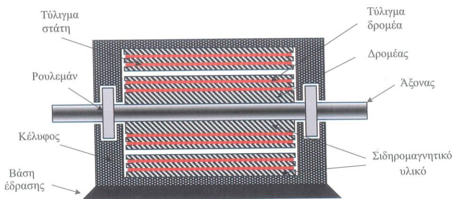
Εικόνα 1-1 Στοιχειώδης ηλεκτρική μηχανή
