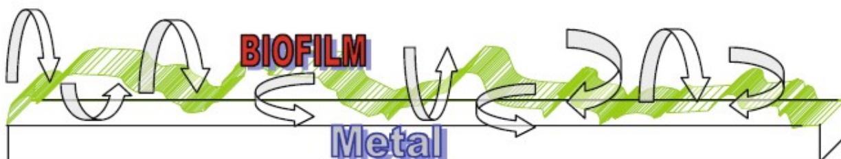
Εικόνα 15. Είσοδος και έξοδος των αερίων στο βιοφίλμ. Πηγή: Microbiologically influenced Corrosion Reza Javaherdashti -book series (EMP)
