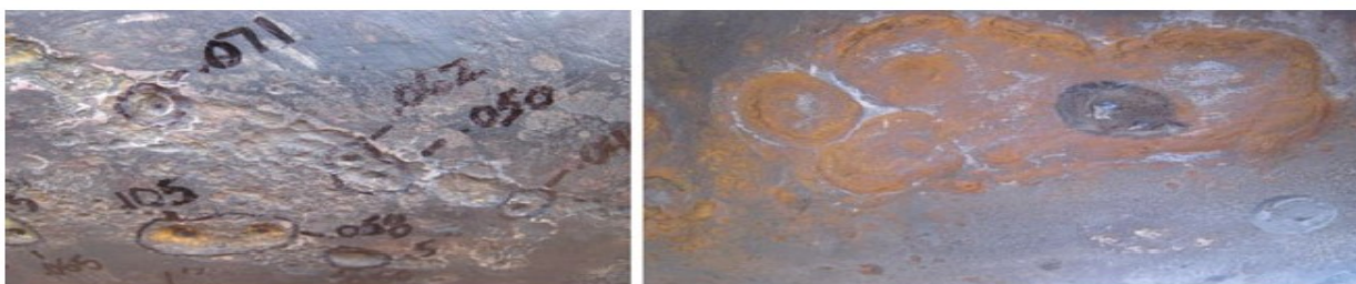
Εικόνα 17. Διάβρωση τύπου βελονισμού σε μεταλλική επιφάνεια. Πηγή: NACE International
