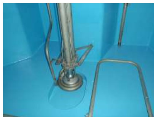
Εικόνα 28. Πυθμένας δεξαμενής φορτίου με τελική στρώση βαφής. Πηγή: Chemco Int.
