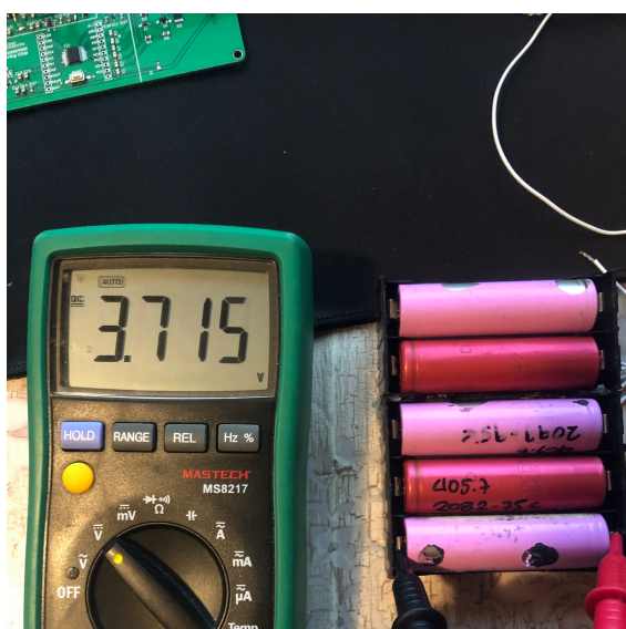
Σχήμα 6.4: Μέτρηση τάσης πρώτου κελιού.
