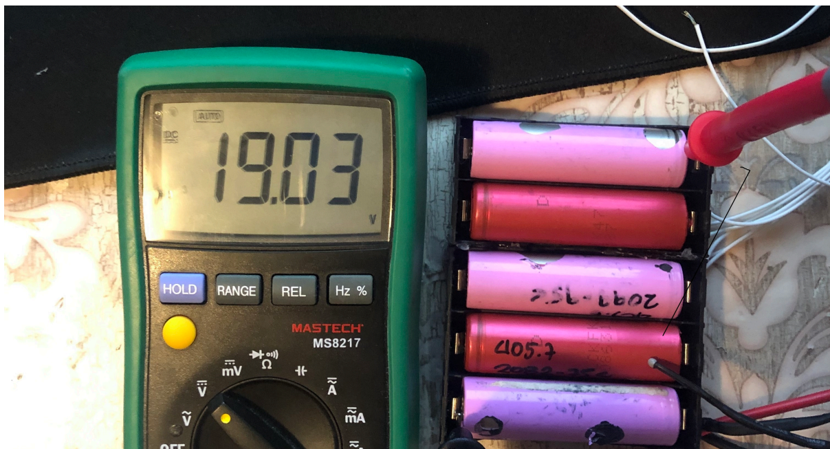
Σχήμα 6.7: Επαλήθευση της συνολικής τάσης με πολύμετρο.
