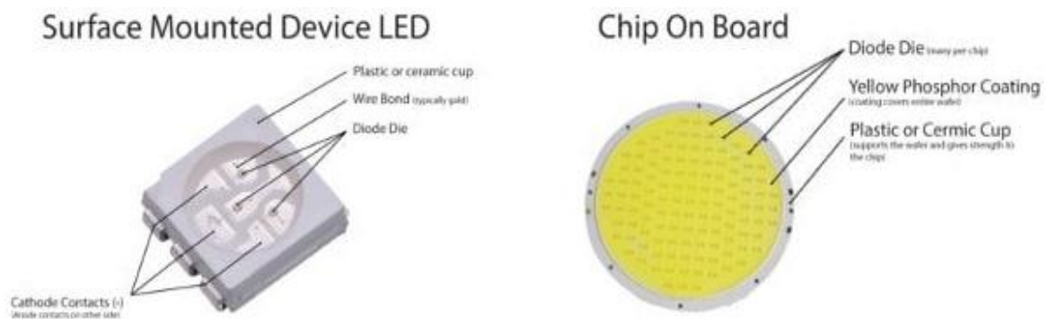
Εικόνα39: LED τύπου SMD (keasy-shenzhen.com, 2022) και COD (electronicsmaker.com, 2022)
