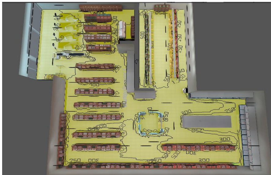
Εικόνα 51:υπάρχον φωτισμός καταστήματος
