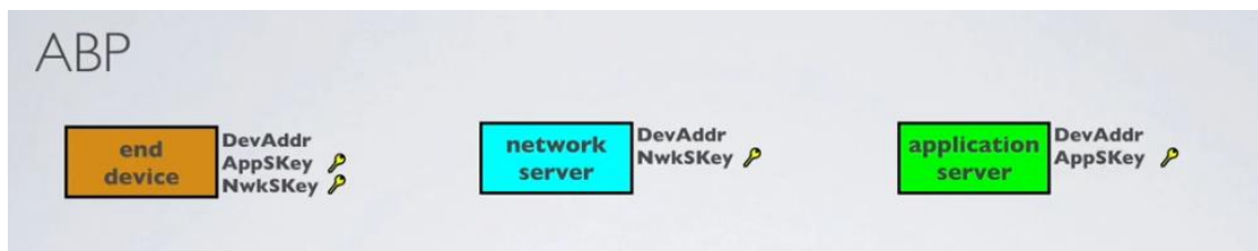
Εικόνα 2.33 – Μέθοδος ενεργοποίησης ABP, απαιτούμενα κλειδιά λειτουργίας (Πηγή: https://www.youtube.com/watch?v=KrNDOBzhxM )
