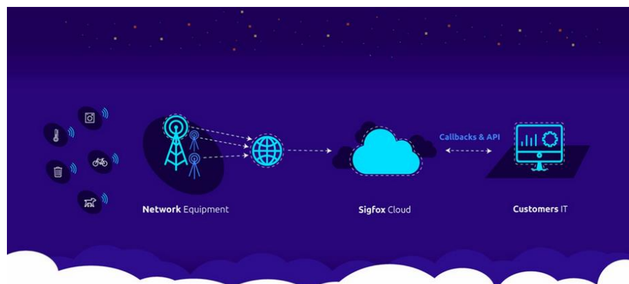
Εικόνα 2.3 – Τοπολογία δικτύου Sigfox (Πηγή: https://build.sigfox.com/sigfox-radio-configurations-rc )
