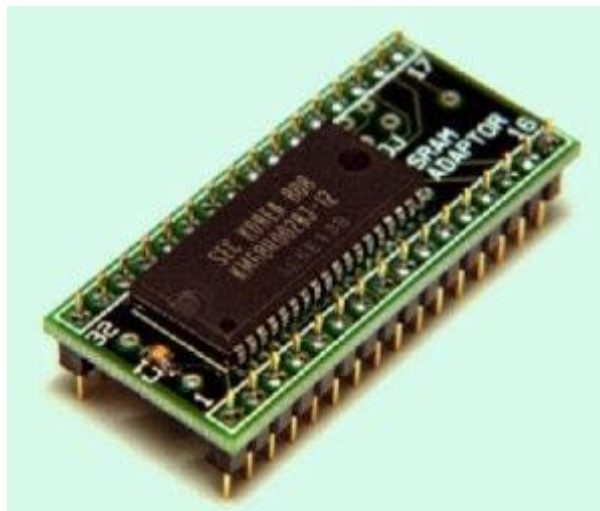
Εικόνα 2.2.7.2: Μνήμη SRAM. Προσαρμόστηκε από: ( © Technology Share ® , 2011 )
