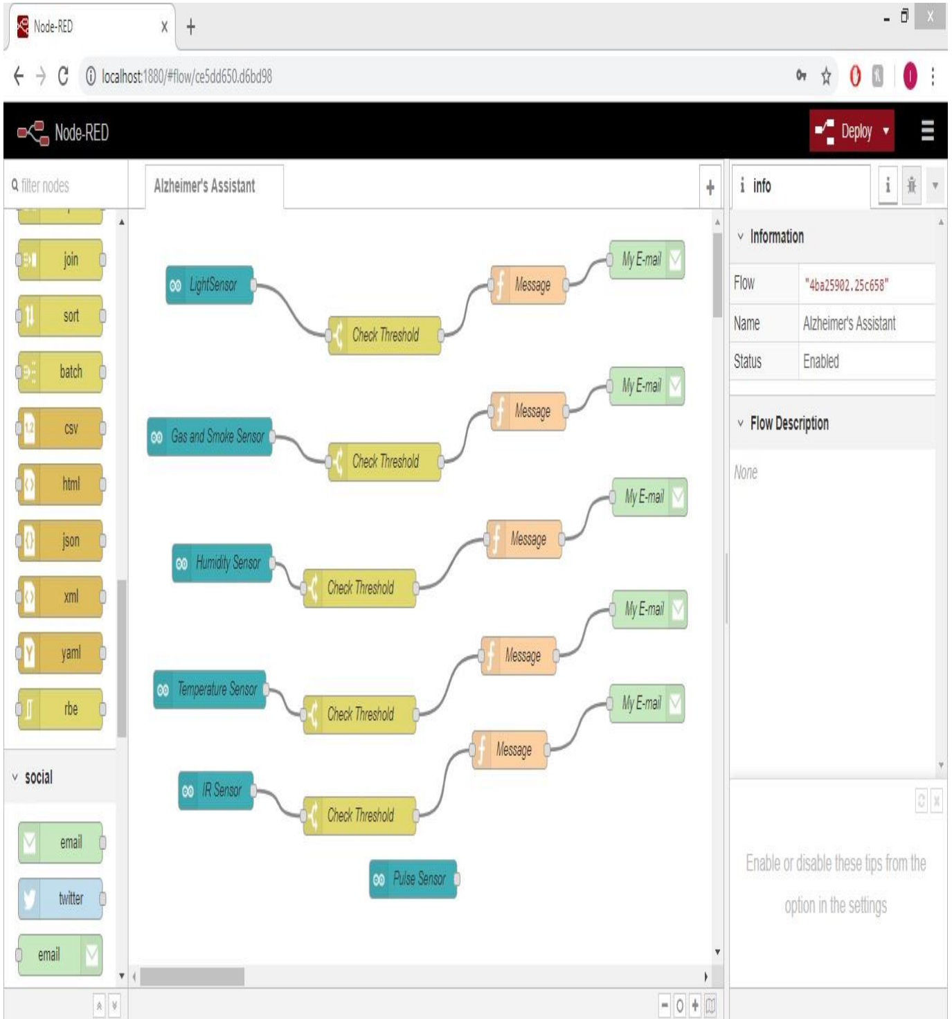
Εικόνα 4.3.37: Συνδεσμολογία και σχηματική απεικόνιση εντολών της Node – Red, για επιτυχή αποστολή email και λειτουργία, όλων των αισθητήρων συνδυαστικά με εκείνη. Προσαρμόστηκε από: ( Γκότσης & Παγώνης, 2018 )
