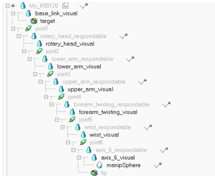
Σχήμα 114: Η δομή του βραχίονα ως hierarchy.
