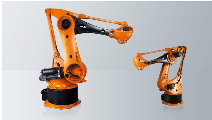
Σχήμα 4: Σχηματική απεικόνιση του ρομποτικού βραχίονα KR 700 PA (4 βαθμών ελευθερίας), για βιομηχανικές εφαρμογές. Πηγή: KUKA Industrial Robots (Kuka, n.d.).
