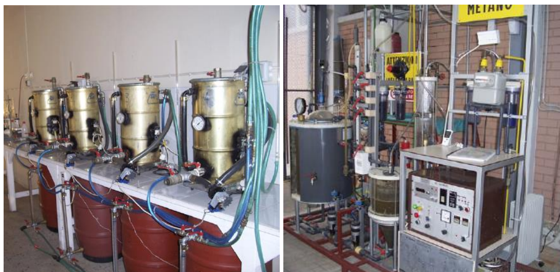
Σχήμα 37 Αριστερά: Χώνευτές εργαστηριακής κλίμακας. Δεξιά: Πιλοτική διάταξη χώνευσης. Πηγή: (Gelegenis, et al., 2007)
