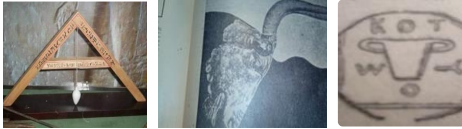
Εικ. 49 (αριστερά) Το Γράμμα Αλφα αποτελούσε σύμβολο ζυγοστάθμισης στην Αρχαία Αίγυπτο, ενώ χρησιμοποιούνταν και για την μέτρηση υψομετρικών διαφορών γεωμετρικών σημείων (Βρέθηκε στον τάφο του Αρχιτέκτονα Sennedjem στην Deir el Medina κοντά στις Θήβες, 19 η Δυναστεία 1300 π.χ.) / Εικ. 50 (κέντρο) Ανάγλυφος Κεφαλή Ταύρου κρούει τα κέρατα κοσμούσα την στοάν του ανακτόρου της Κνωσού -δείγμα Γλυπτικής του Μινωικού Πολιτισμού Εικ. 51 (δεξιά) Ταυρόμορφο νόμισμα της θρακικής θεάς Κοττυτούς σχετιζόμενη με την Μεγάλη Μητέρα Γη Κυβέλη (περίπου 6 ο .π.χ.)
