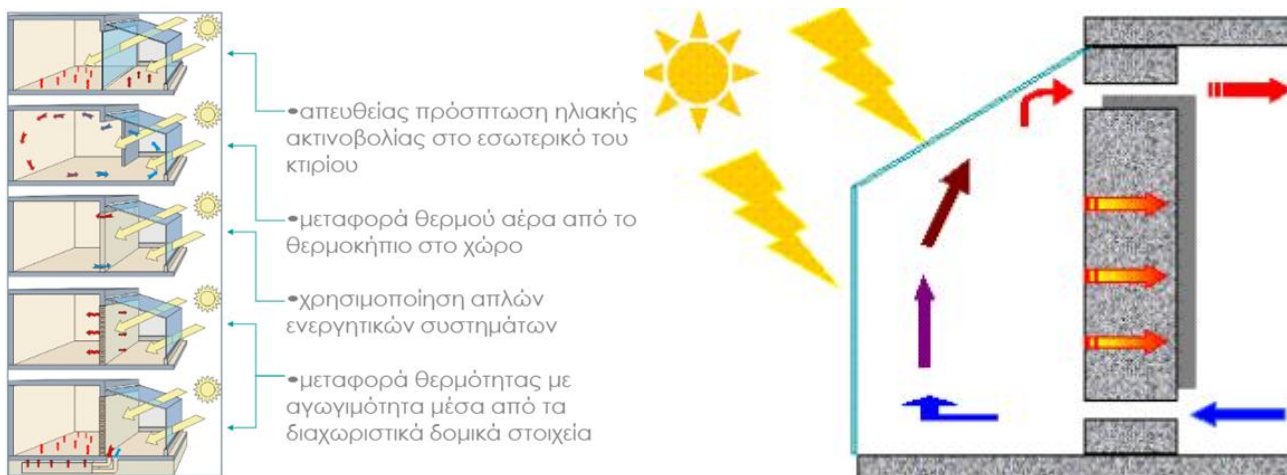
Σχήμα 5.1.2.2.1.: Τρόπος σύνδεσης του ηλιακού θερμοκηπίου με το κύριο κτίριο και η κυκλοφορία του αέρα που είναι στο θερμοκήπιο [3].
