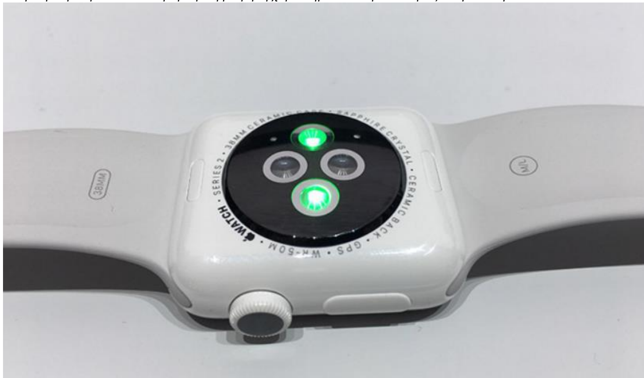
Εικόνα 4.15 Αισθητήρες έξυπνου ρολογιού για την καταγραφή των καρδιακών παλμών 17
