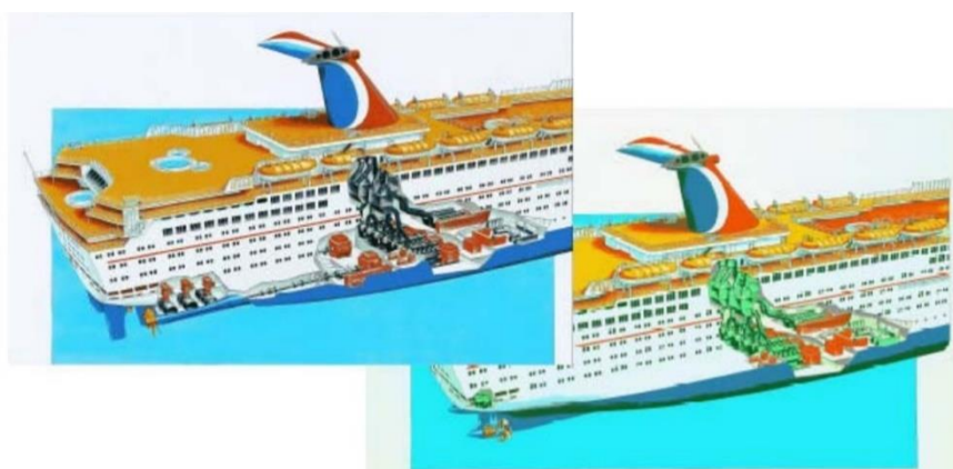
Εικόνα 2.2: Κρουαζιερόπλοιο M/S Elation με azipod (κάτω δεξιά) με σημαντικό ελεύθερο χώρο.
