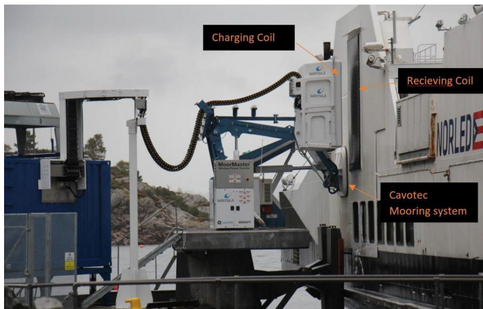
Εικόνα 3.10: Η ασύρματη φόρτιση σε πλήρη λειτουργία μέσω της εταιρείας Cavotec.
