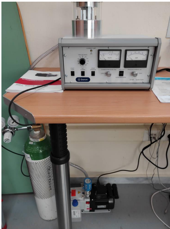
Εικόνα 9: Διάταξη συστήματος μηχανημάτων επιμετάλλωσης
