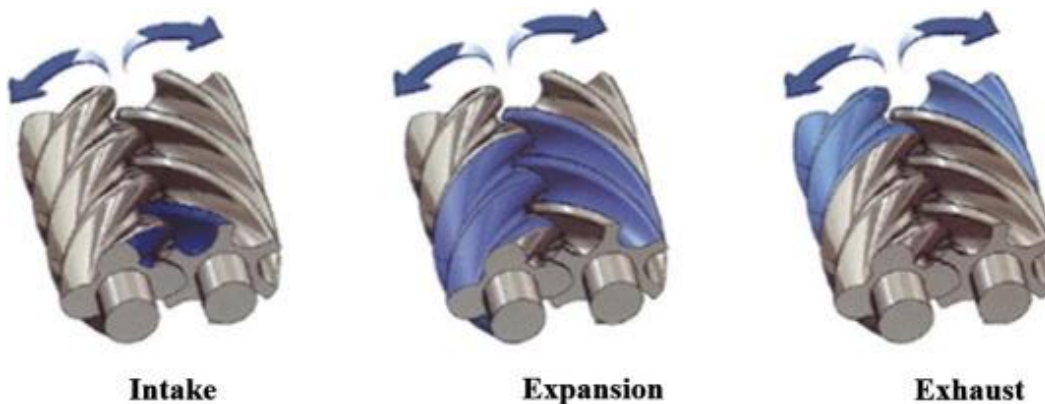
Εικόνα 7. Λειτουργία στροβίλου τύπου screw. 20
