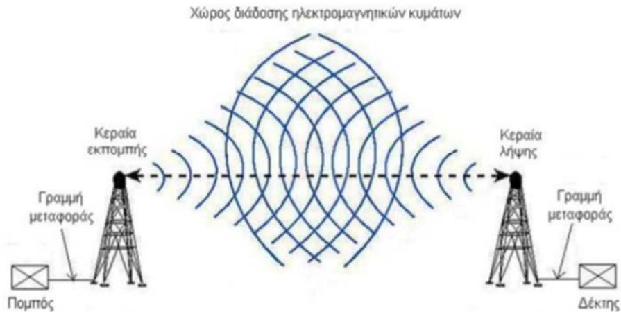
Σχήμα 1.1: Σύστημα κεραίας εκπομπής και λήψης (Chatterjee, 2018)
