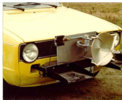
Σχήμα 1.2: Πρωταρχικά ραντάρ στην αυτοκινητοβιομηχανία. (WU, 2016)
