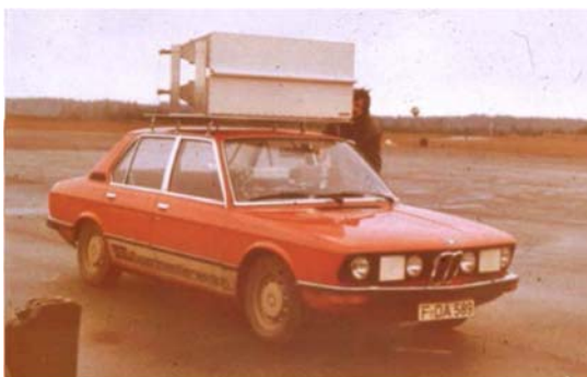
Σχήμα 1.2: Πρωταρχικά ραντάρ στην αυτοκινητοβιομηχανία. (WU, 2016)
