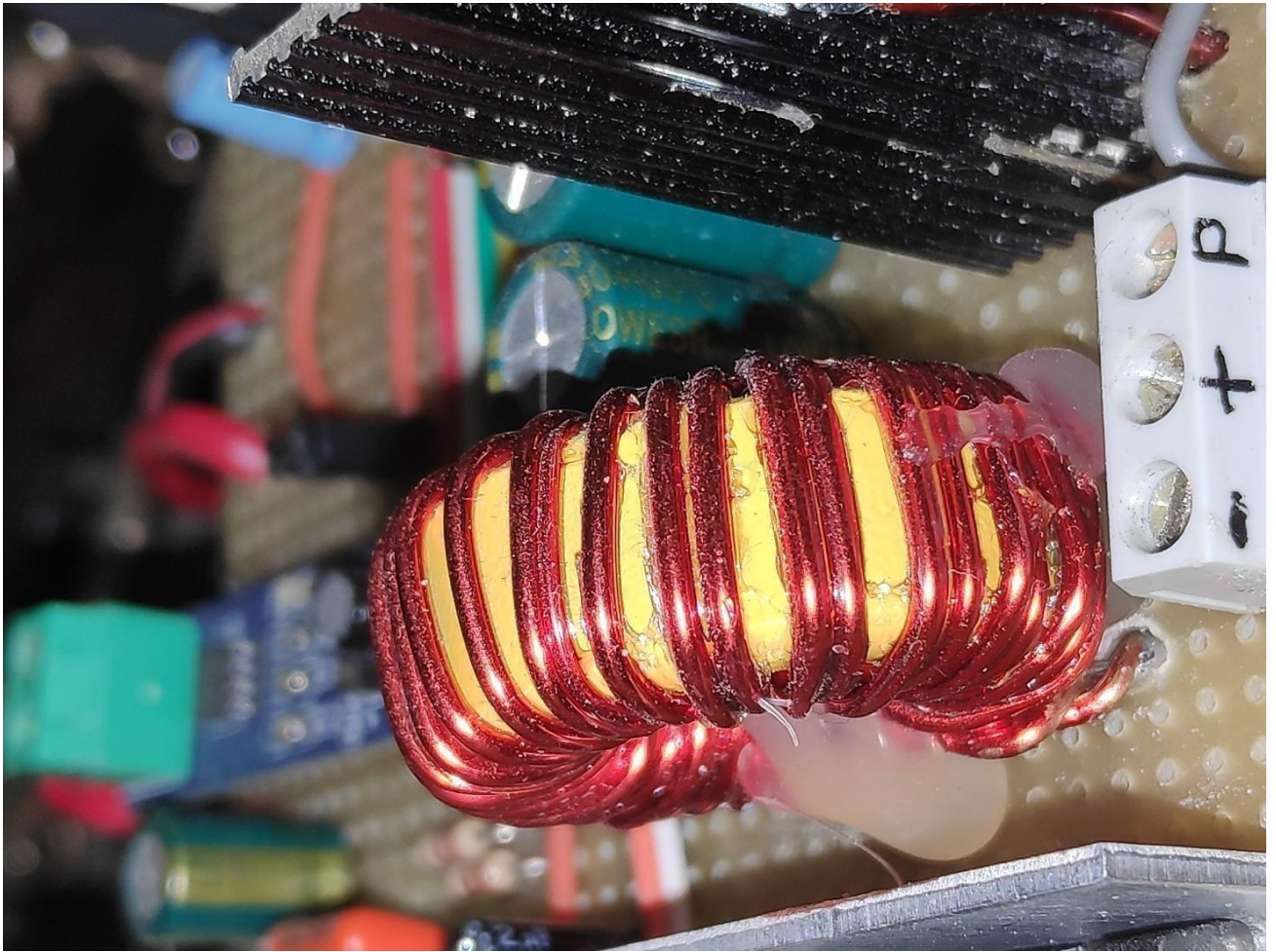
Ε-3.4.1 Πηνίο που χρησιμοποιήθηκε σε ένα από τα πειράματα.
