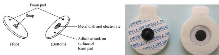
Σχήμα 2.6: Υγρό ηλεκτρόδιο Ag/AgCl
