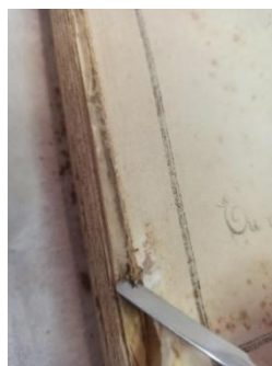
Εικόνα 98. Καθαρισμός των υπολειμμάτων με σπάτουλα στο χαρτί και στο σπάγκο.
