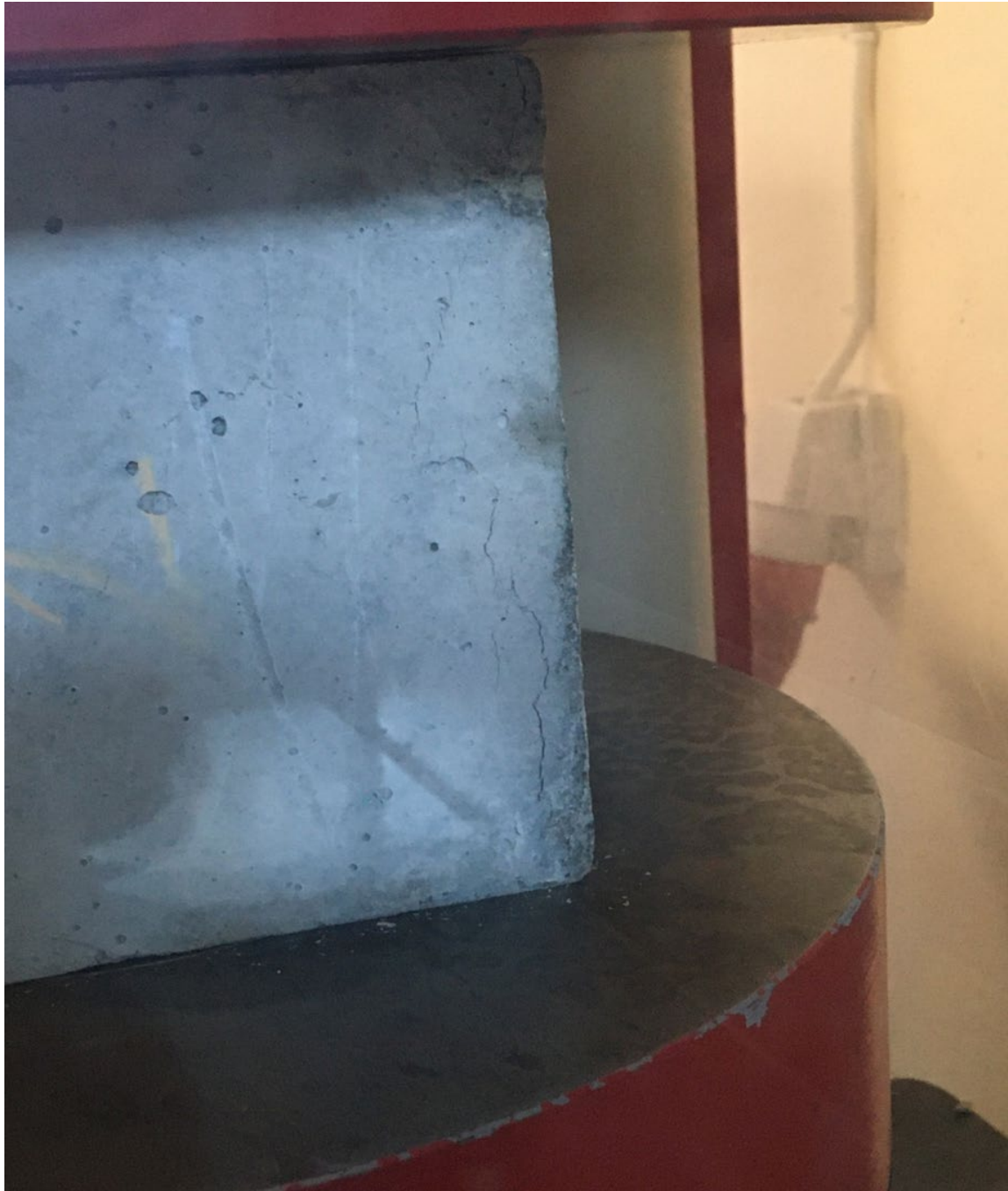
Εικόνα 18. Παρουσιάζεται ένα χαρακτηριστικό κυβικό δοκίμιο μετά το πέρας της δοκιμής σε μονοαξονική θλίψη και παρατηρείται η σχετική «ρηγμάτωση»του.
