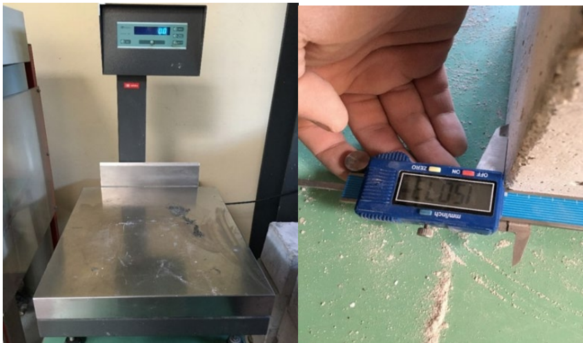
Εικόνα 16. Ζυγαριά Μέτρησης βάρους & διαστάσεις κυβικού δοκιμίου
