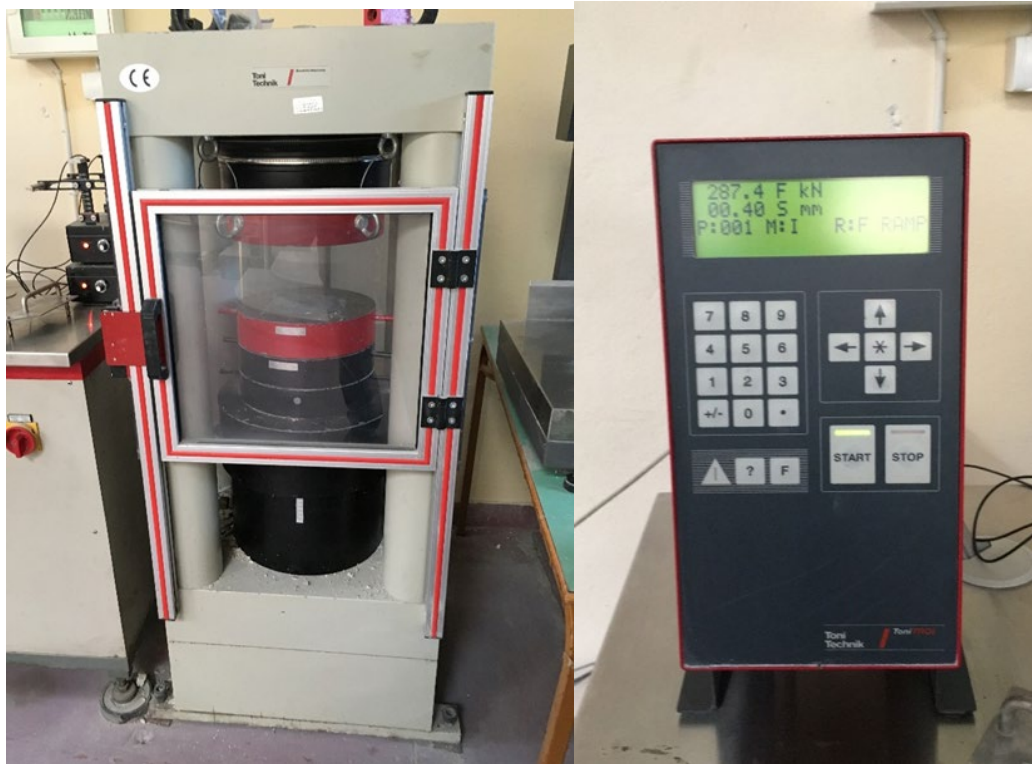
Εικόνα 17. Διάταξη μηχανής μονοαξονικής κάμψης στο Εργαστήριο Οπλισμένου Σκυροδέματος του Π.Α.Δ.Α
