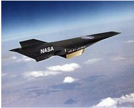
Αναπαράσταση του X-43A με το σκράμτζετ στην κάτω πλευρά.
