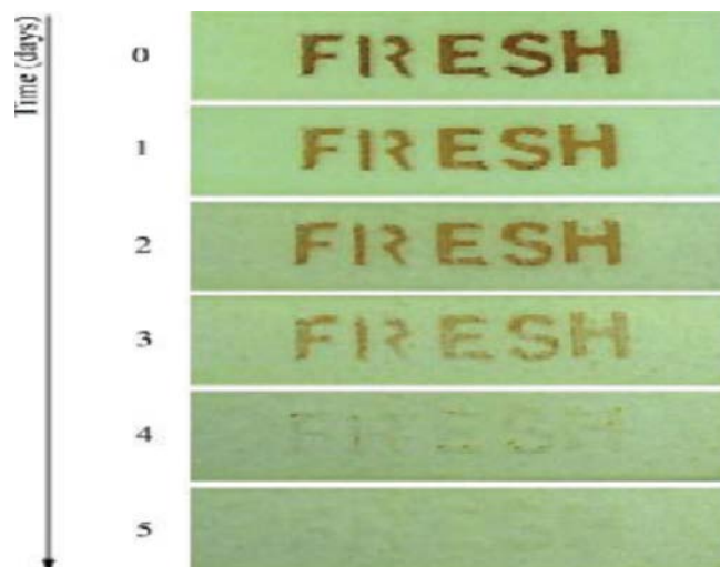
Εικόνα 19. Μεταβολή του χρώματος του δείκτη και συσχέτιση της κατάστασης φρεσκότητας τροφίμων με βάση τη μεταβολή αυτή (Esmaeil Mohammadian, 2020).
