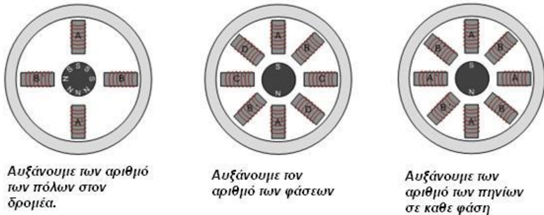
Εικόνα 4.3: Βελτιστοποίηση βηματικού κινητήρα μόνιμου μαγνήτη [18]
