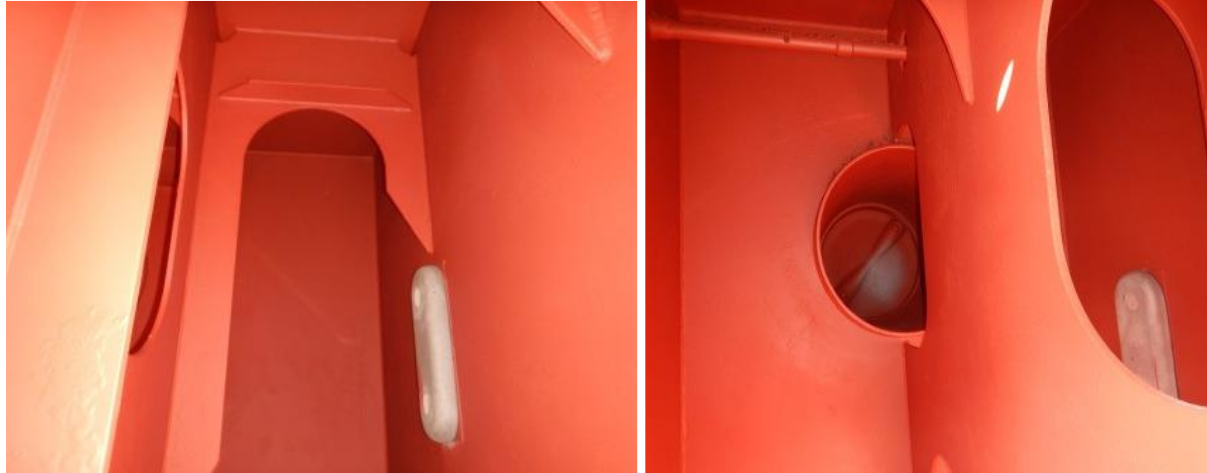
Εικόνα 29: Εγκατεστημένα ανόδια στο sea chest (Report of S.S V)
