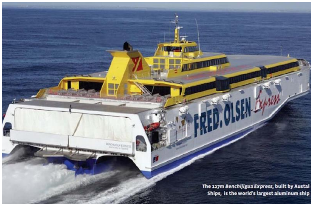
Εικόνα 2: Benchijigua Express , Το μεγαλύτερο πλοίο στον κόσμο κατασκευασμένο από αλουμίνιο (Djukanovic, 2016)
