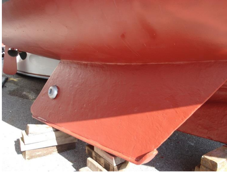
Εικόνα 31: Εγκατεστημένη άνοδος στο παρατροπίδιο του πλοίου (Log, 2010)
