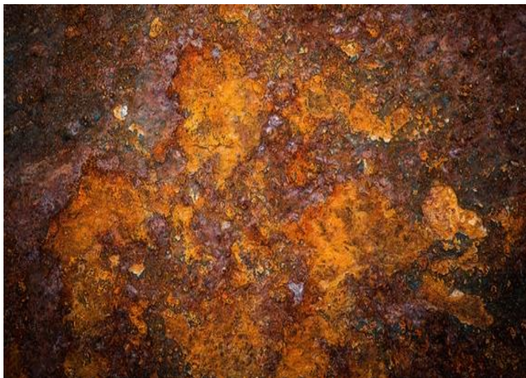
Εικόνα 8: Στρώμα σκουριάς σε μεταλλική επιφάνεια (Rousseaux, 2018)
