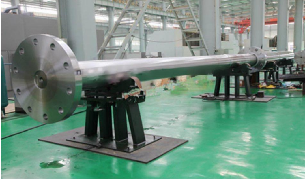
Εικόνα 4: Άξονας πλοίου, κατασκευασμένος από Τιτάνιο ( Chongqing New Maritime Import & Export Co, 2020 )
