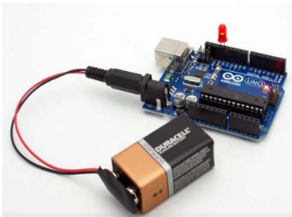
Εικόνα 55: Τροφοδοσία Arduino με μπαταρία 9V.[15]
