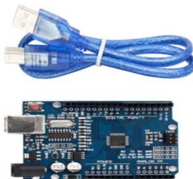
Εικόνα 57: Τροφοδοσία Arduino με καλώδιο USB.
