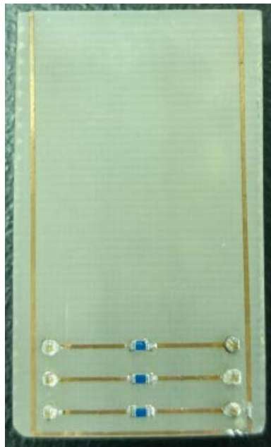
Εικόνα 53: Αισθητήρας ροής με θερμίστορ PTC υψηλής ακριβείας.
