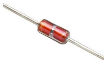
Εικόνα 22: Θερμίστορ τύπου NTC
