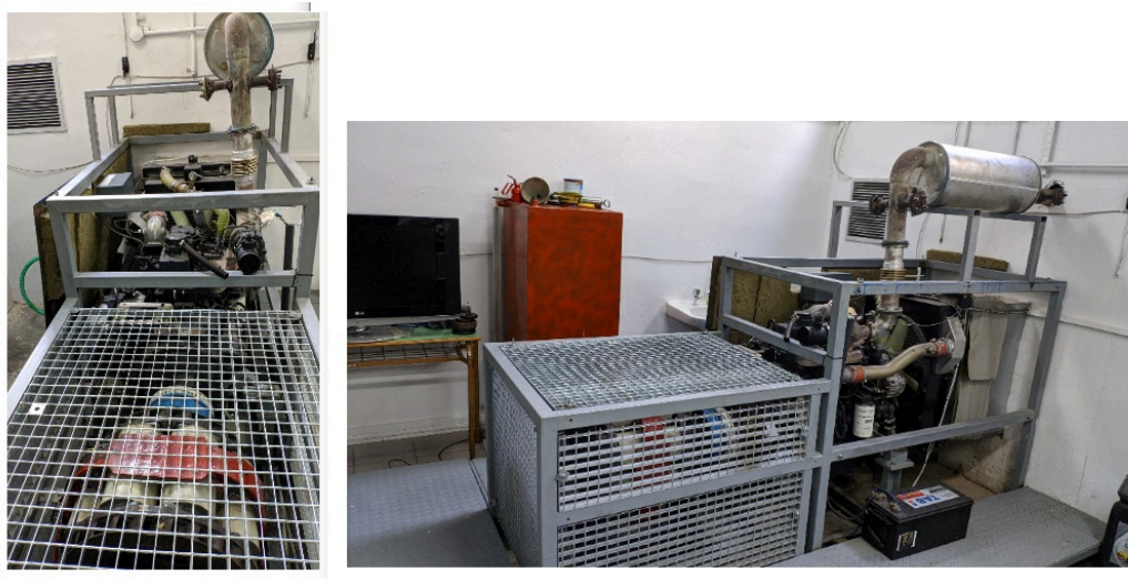
Εικόνα 54: Κινητήρας και ηλεκτρομαγνητική πέδη εργαστηριακής κλίνης
