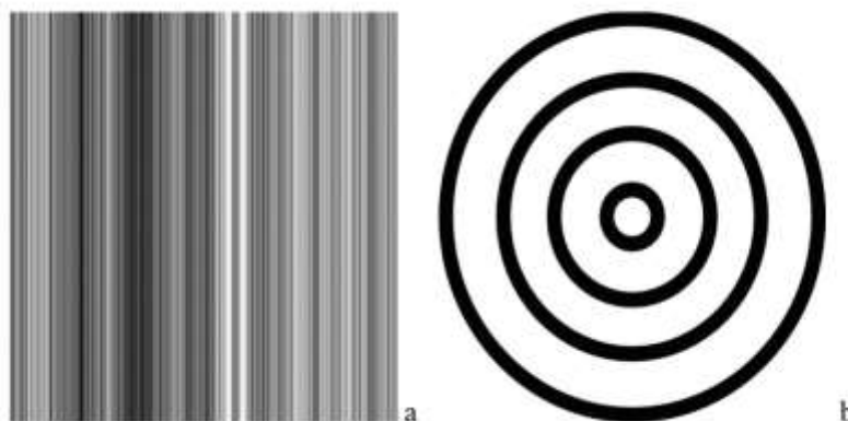
Εικόνα 2.5. Η υφή της εικόνας (α) χαρακτηρίζεται από περιορισμένο πλήθος long runs στην κάθετη διεύθυνση και από ένα τεράστιο πλήθος short runs σε όλες τις υπόλοιπες διευθύνσεις. Επίσης η ένταση των runs παρουσιάζεται ομοιόμορφα κατανεμημένη σε όλα τα επίπεδα έντασης (GLN=0.082) ενώ
