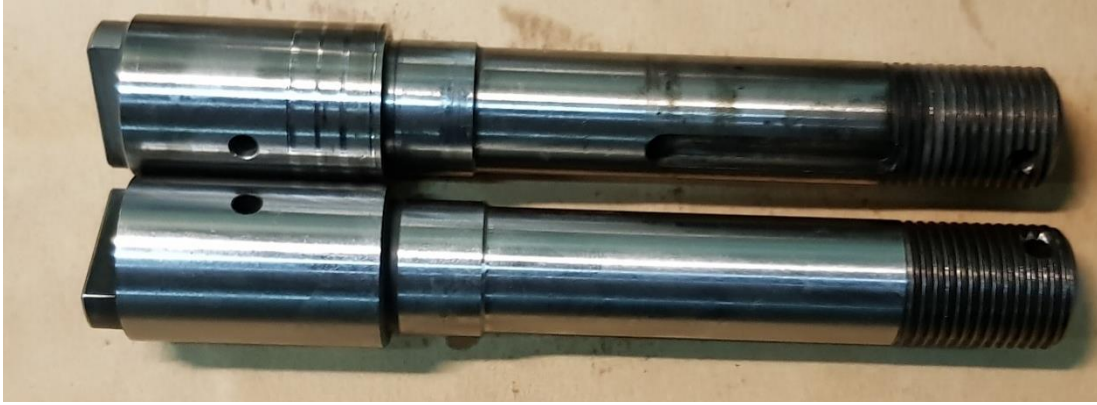
Σχήμα 12-4 Φθορές στον πρωτεύον άξονα κίνησης (driveshaft).
