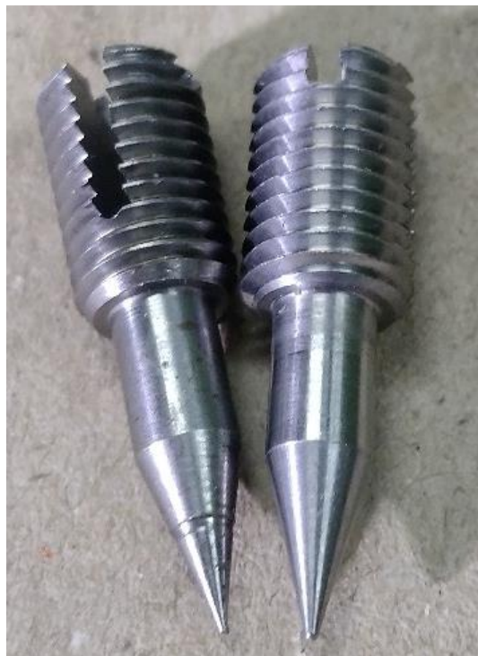
Σχήμα 12-5 Φθορές στην βαλβίδα ευαισθησίας (αριστερά η φθαρμένη - δεξιά η καινούρια)
