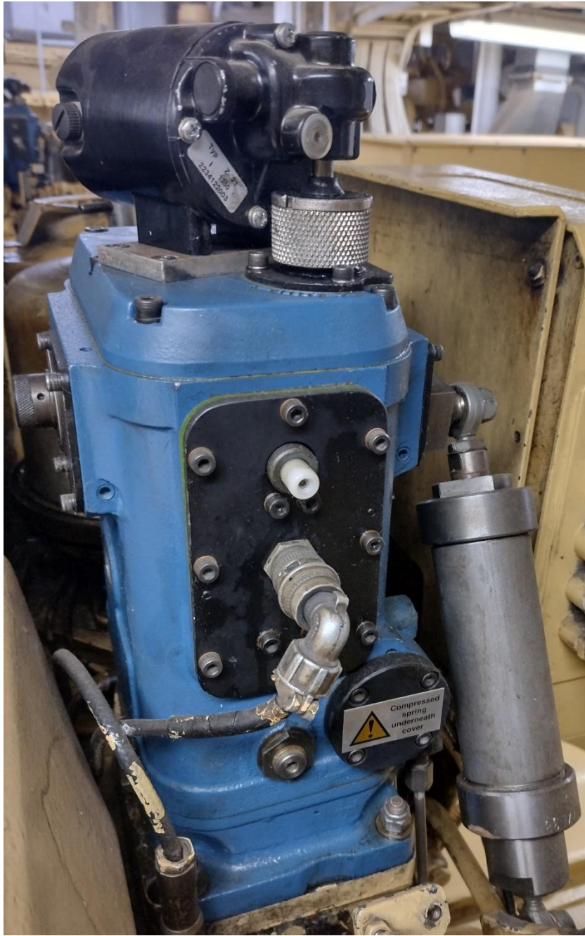
Σχήμα 2-3 Αυτόματος ρυθμιστής στροφών Eurora (με μπλε χρώμα), τοποθετημένος σε πετρελαιοκίνητη μηχανή εσωτερικής καύσης.
