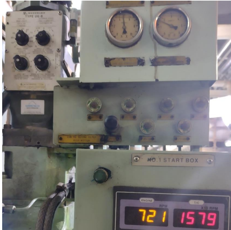
Αυτόματος ρυθμιστής στροφών UG - 8 τοποθετημένος σε πετρελαιοκινητήρα (πάνω αριστερά). Κάτω δεξιά είναι η ταχύτητα περιστροφής του κινητήρα (721 rpm).
