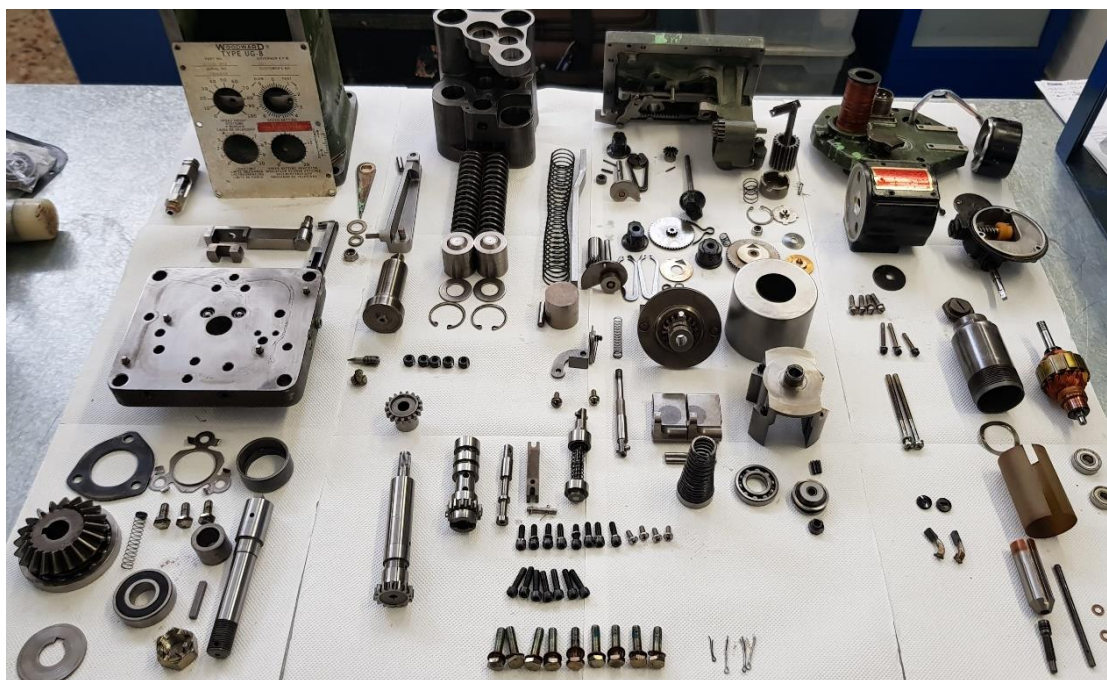
Σχήμα 6-2 Αυτόματος ρυθμιστής στροφών woodward UG-8 αποσυναρμολογημένος υπό μορφή exploded view. Διακρίνονται τα εξαρτήματα ομαδοποιημένα μεταξύ τους με σκοπό να γίνει ενδελεχής έλεγχος για φθορές.
