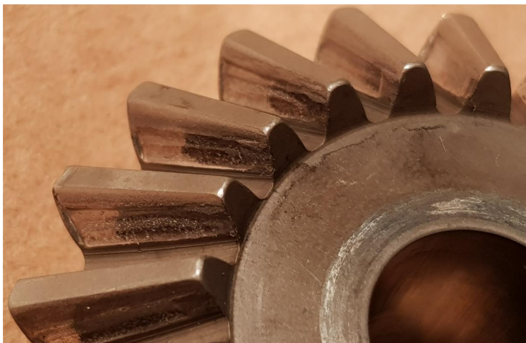
Σχήμα 12-7 Κωνικός οδοντωτός τροχός (bevel gear) ο οποίος συνδέεται με τον πρωτεύον άξονα και τον αντίστοιχο κωνικό οδοντωτό τροχό της μηχανής.
