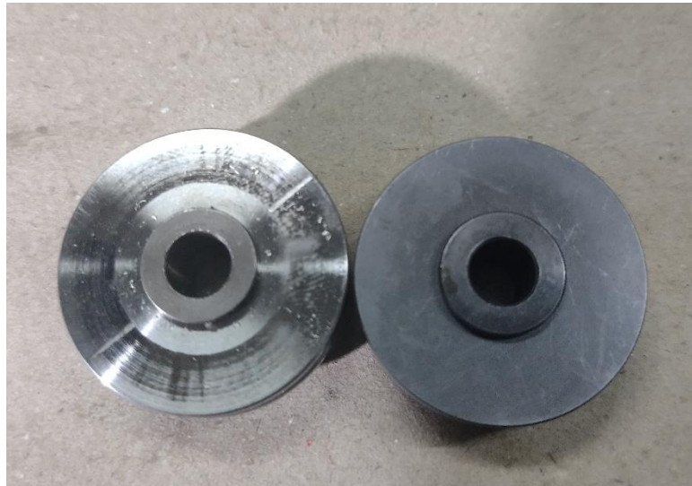
Σχήμα 12-6 Φθορές στον ωστικό τριβέα (Thrust Bearing). Αριστερά ο φθαρμένος τριβέας, δεξιά ο καινούριος.
