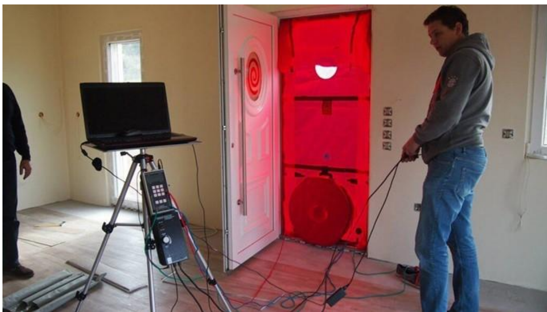
Εικόνα 34: Διαδικασία ελέγχου αεροστεγανότητας " blower door test" σε παθητική κατοικία της Easy Green στο Πόρτο Ράφτη
