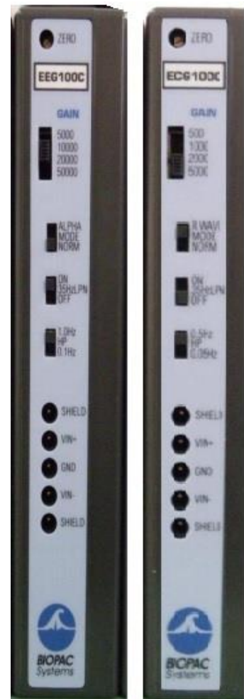
Εικόνα 39. Μονάδες Ενίσχυσης ΗΚΓ – ΗΕΓ Biopac MP150
