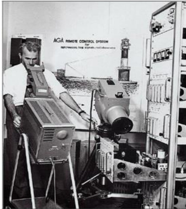
Εικόνα 34. Κάμερα Θερμογραφίας, Μοντέλο 650 της εταιρείας AGA κατασκευής 1965
