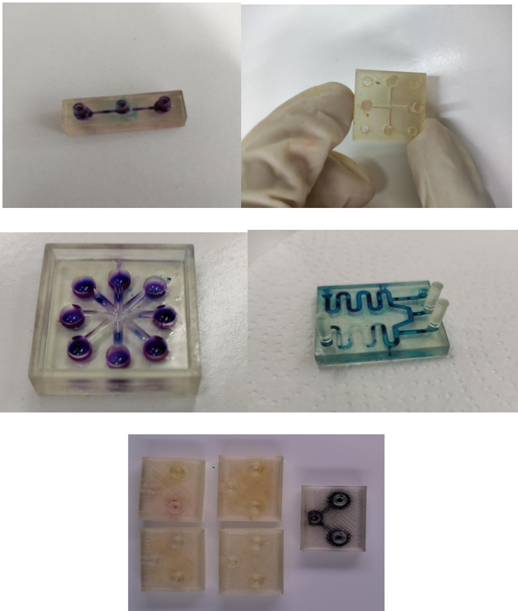
Εικόνα 3.5: εκτυπωμένες συσκευές μικρορευστομηχανικής
