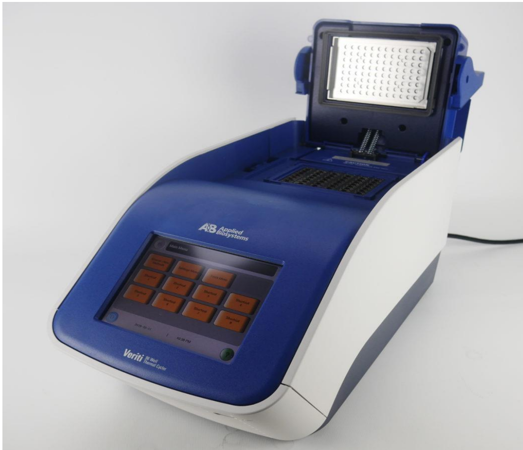
Εικόνα 3.1: Το μηχάνημα της PCR- Veriti™ 96-Well Fast Thermal Cycler (Applied Biosystems)
