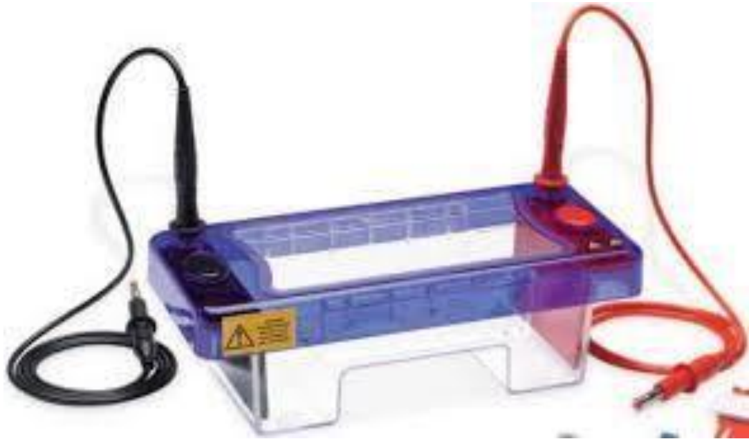
Εικόνα 3.2: Η συσκευή ηλεκτροφόρησης Mini Single Cell Electrophoresis Chamber
