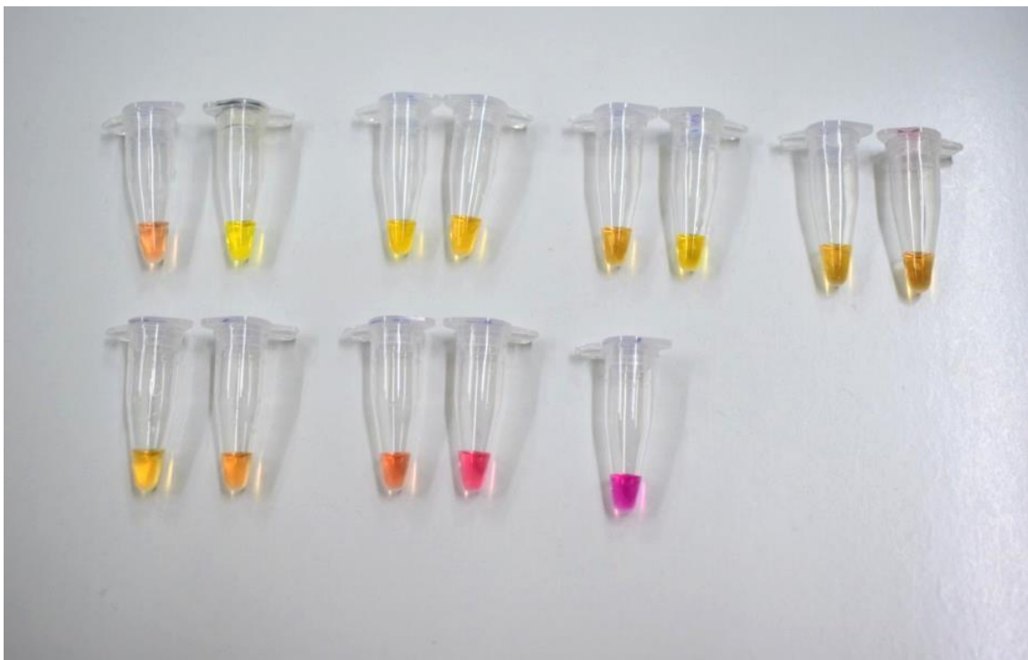
Εικόνα 4.10: Απεικόνιση της χρωματικής αλλαγής στις διαδοχικές δεκαδικές αραιώσεις στο πέρας της διαδικασίας της LAMP.
