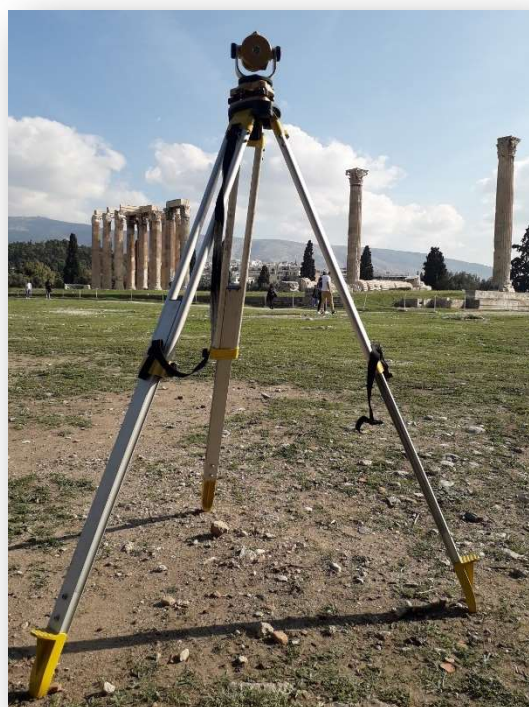
Εικόνα 58. Πρίσμα τοποθετημένο στον τρίποδα.
