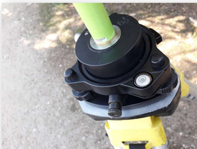
Εικόνα 35. Οριζοντίωση - Κατακορύφωση δέκτη GPS.
