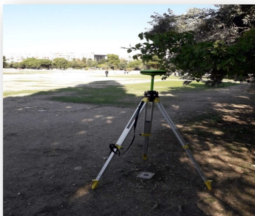
Εικόνα 33. Τοποθέτηση δέκτη GPS σε τριγωνομετρικό σημείο.
