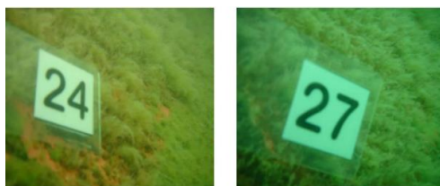
Εικόνα 7: Παράδειγμα στο οποίο διακρίνεται διαφορετικός βαθμός ρύπανσης στα ποικίλα τμήματα που διαθέτει το κύτος
