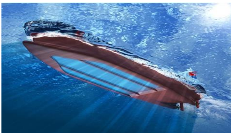
Εικόνα 22: Πλοίο που διαθέτει τεχνολογία ACS της Stena Bulk
