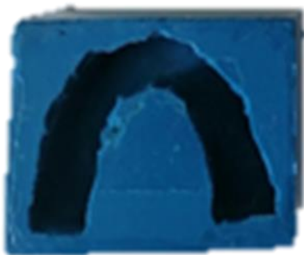
Εικόνα 17: Τελικό αποτέλεσμα δυο θηλυκών καλουπιών από σιλικόνη.
