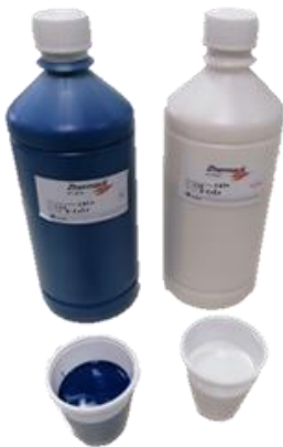
Εικόνα 16: α) Το μπλε μπουκάλι είναι η βάση της σιλικόνης, β) το λευκό μπουκάλι είναι ο καταλύτης για την δημιουργία της σιλικόνης
