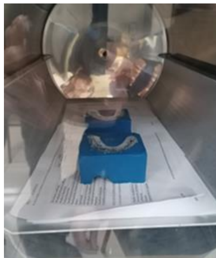
Εικόνα 20: Το καλούπι σιλικόνης με την ρητίνη, που είναι μέσα στον φούρνο κενού.(Φαίνονται οι φυσαλίδες που σκάνε).
