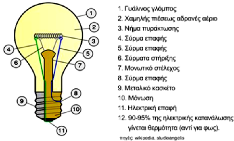
Εικόνα 1.1.9: Μέρη του λαμπτήρα πυράκτωσης , (Βικιπαίδεια, 2021)
