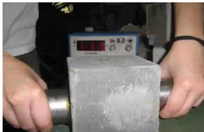
Εικόνα 4-7: Διάγραμμα συστήματος μέτρησης και καταγραφής της μεθόδου των υπερήχων (πάνω) & εφαρμογή της μεθόδου σε κυβικό δοκίμιο (κάτω)
