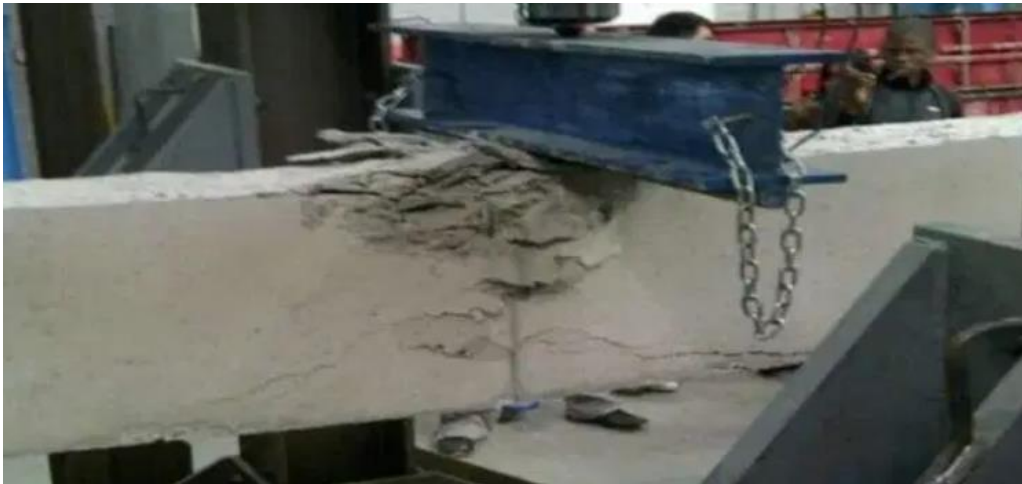
Εικόνα 2-2: Καμπτική θλιπτική αστοχία
