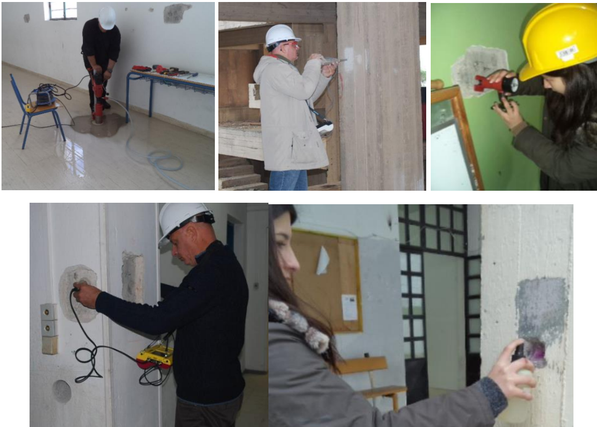
Εικόνα 4-1: Μέθοδοι ποιοτικού ελέγχου του σκυροδέματος [46]. Από πάνω και ωρολογιακά : α) Πυρηνοληψία από πλάκα, β) Εφαρμογή κρουσίμετρου, γ) Μέθοδος εξόλκευσης ήλου, δ) Μέτρηση βάθους ρωγμής με υπερήχους, ε) Έλεγχος ενανθράκωσης σκυροδέματος με ψεκάσμο διαλύματος φαινολοφθαλείνης
