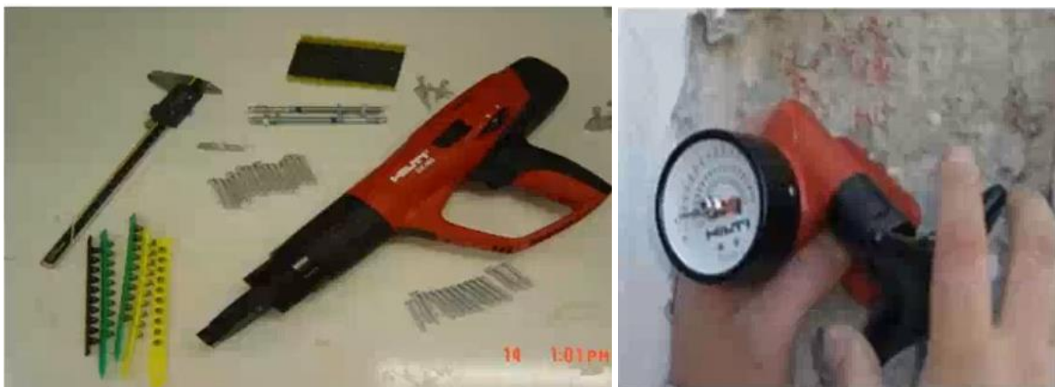
Εικόνα 4-5: Εργαλεία που χρησιμοποιούνται στην τεχνική εξόλκευσης ήλου. Ειδικός εκτοξευτής με τους πρότυπους ήλους αριστερά και εξολκέας με δυναμόμετρο δεξιά
