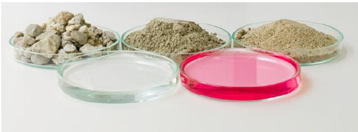
Εικόνα 3-10: Υλικά που αποτελούν το μείγμα ενός σκυροδέματος με τη χρήση πρόσθετων. Από αριστερά προς δεξιά: χοντρόκοκκα αδρανή, νερό, τσιμέντο, υπερευστοποιητής (πρόσμεικτο), λεπτόκοκκα αδρανή (άμμος)
