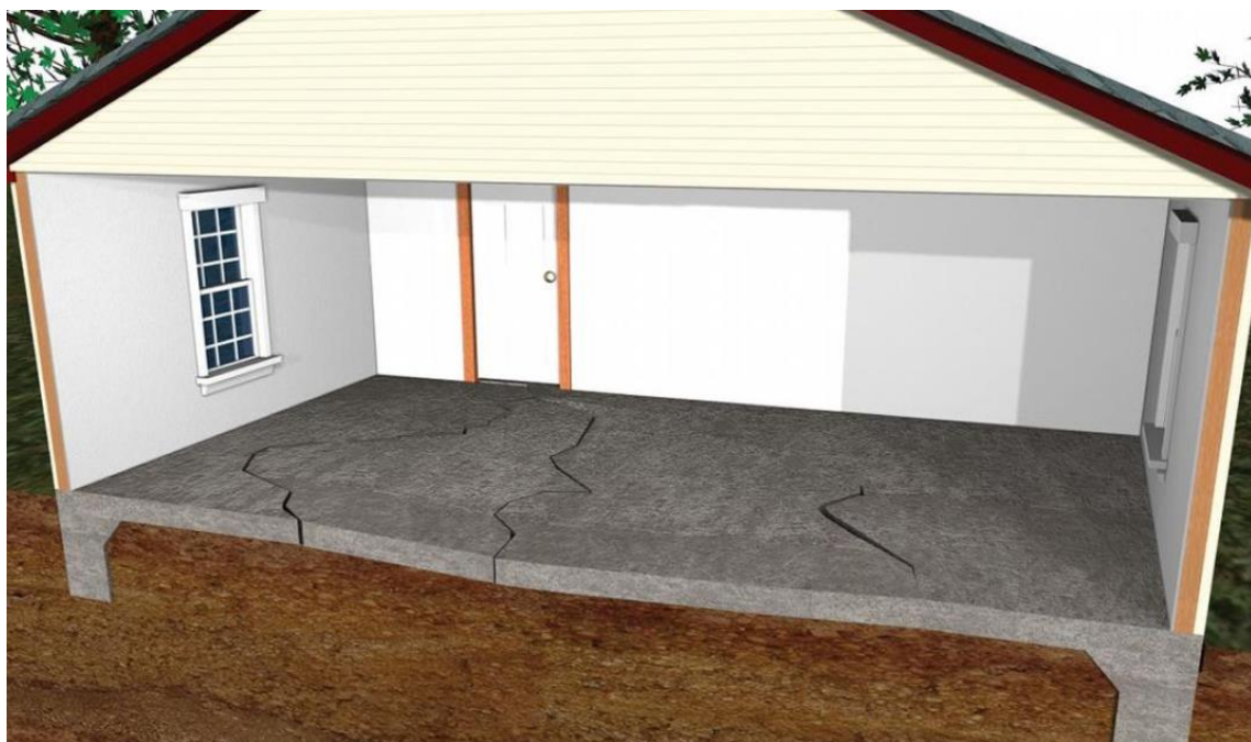
Εικόνα 2-46: Απεικόνιση ρωγμών σε πλάκα λόγω αστοχίας εδάφους
