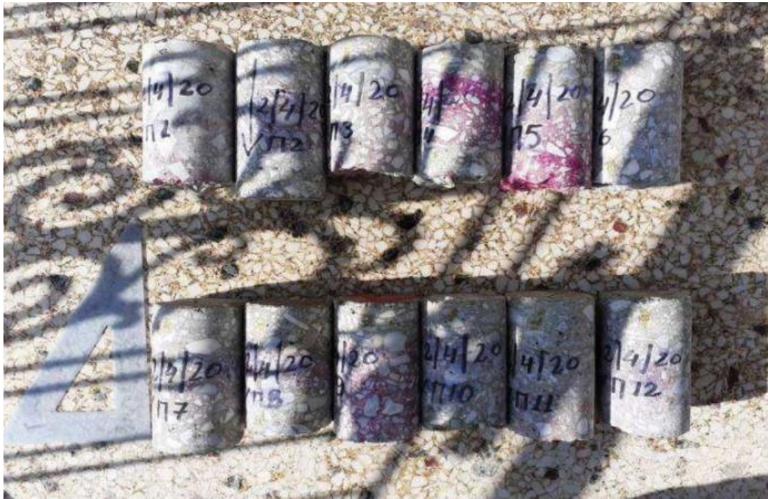
Εικόνα 4-12: Κυλινδρικοί πυρήνες ψεκασμένοι με διάλυμα φαινολοφθαλεΐνης για την εύρεση του πάχους ενανθράκωσης με το χρωματισμένο σημείο να αποτελεί το υγιές σκυρόδεμα
