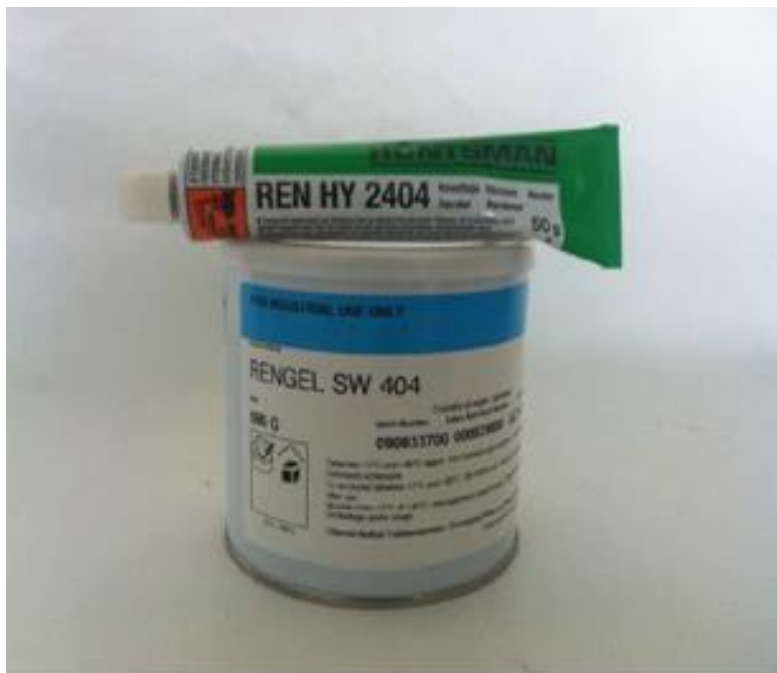
Εικόνα 3-19: Συστατικά πολυμερικής κόλλας. Σκληρυντής (πάνω) & πολυμερές (εποξική ρητίνη) (κάτω)
