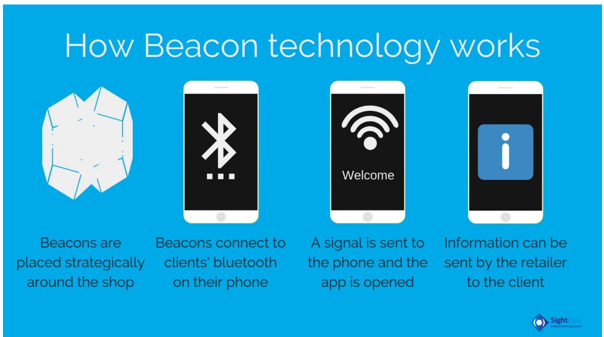
Εικόνα 18 : Λειτουργία της τεχνολογίας Beacon
