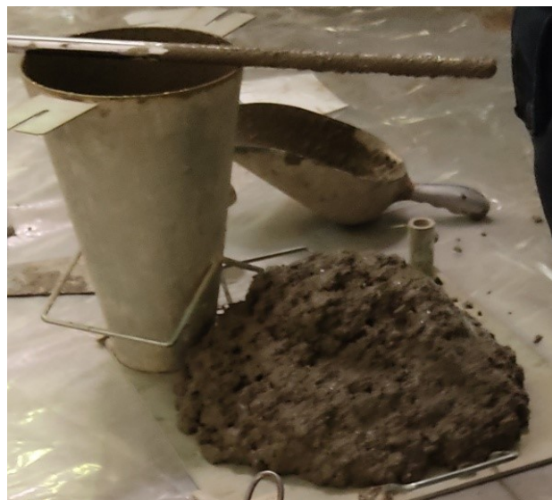
Εικόνα 9.5 : Πραγματοποίηση δοκιμής κάθισης.
