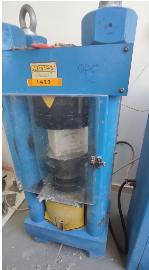
Εικόνα 9.9: Τοποθέτηση του δοκιμίου στην πρέσα και η θραύση του.
