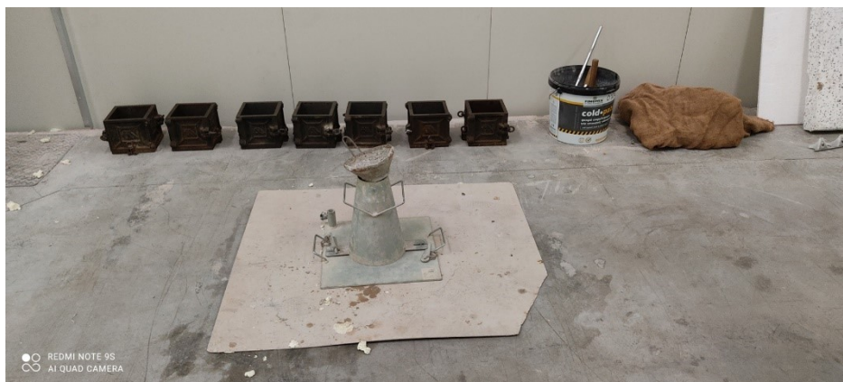
Εικόνα 9.1: Χρήση τάβλας για σωστή εκπόνηση δοκιμής κάθισης.
