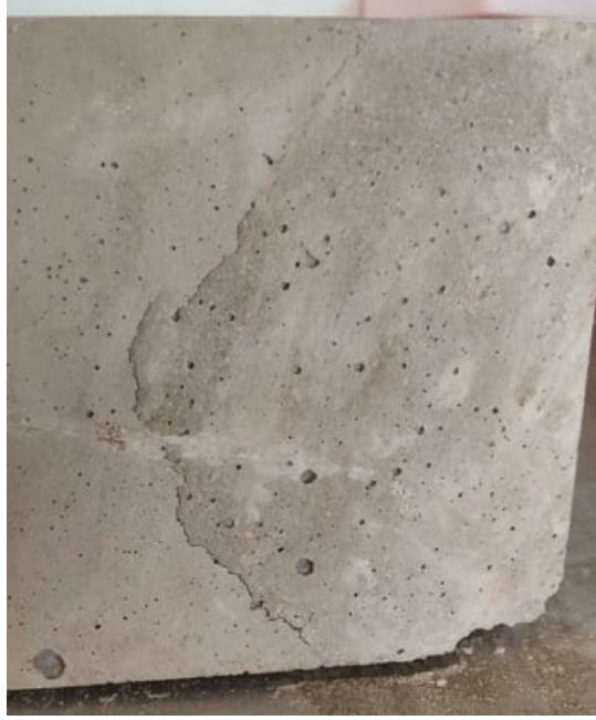
Εικόνα 9.11: Λάθος δειγματοληψία που είχε ως αποτέλεσμα κακό 'δέσιμο' μεταξύ των δύο στρώσεων σκυροδέματος.
