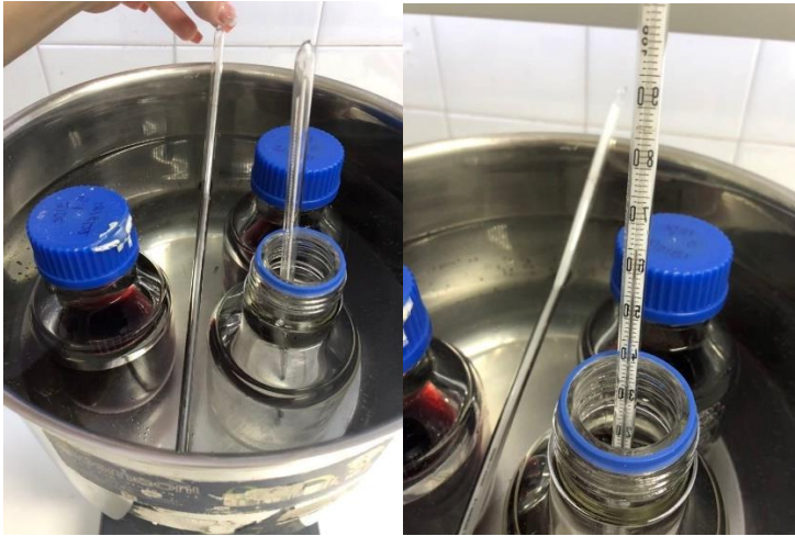
Εικόνα 4: Παρακολούθηση θερμοκρασίας κατά την διάρκεια της παστερίωσης του μείγματος
