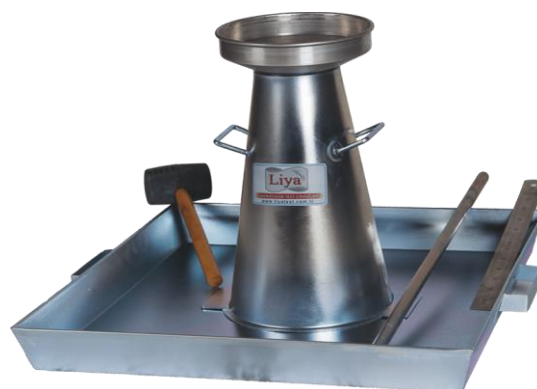
Εικόνα 24: Μεταλλικός κόλουρος κώνος, μεταλλική ράβδος κυκλικής διατομής με στρογγυλεμένα άκρα και μία άκαμπτη (56)
