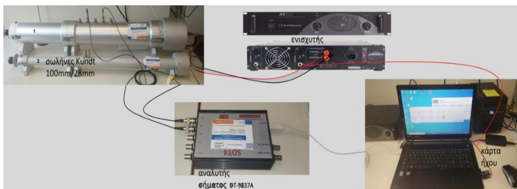
Εικόνα 40: Διάταξη και συνδεσμολογία εργαστηριακού εξοπλισμού για μέτρηση του συντελεστή ηχοαπορρόφησης \alpha .
