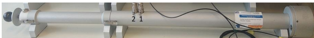
Εικόνα 28: Ο μικρός σωλήνας (28 mm) με δύο υποδοχείς μικροφώνων.
