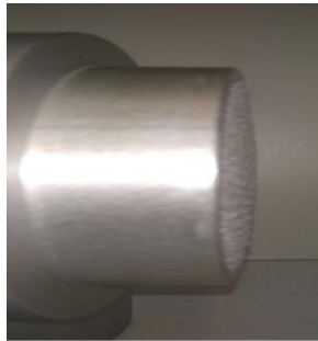
Εικόνα 30: Ευθυγραμμισμένη τοποθέτηση δείγματος σε Σωλήνα Kundt.
