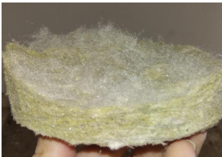
Εικόνα 76: Δείγμα πετροβάμβακα μη προετοιμασμένο σωστά.
