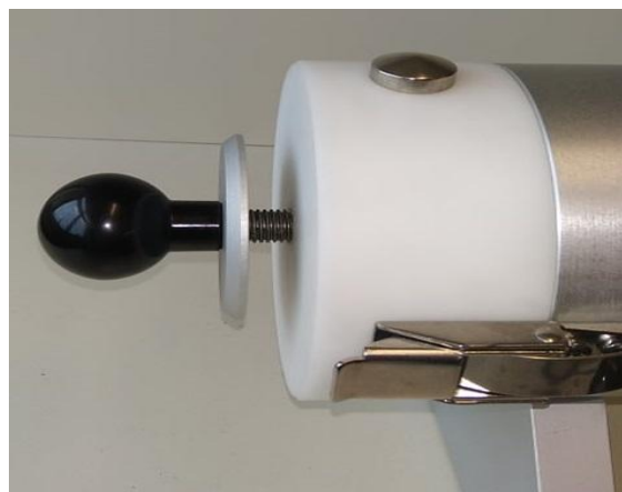
Εικόνα 27: Έμβολο - πιστόνι κυλινδρικού σωλήνα.
