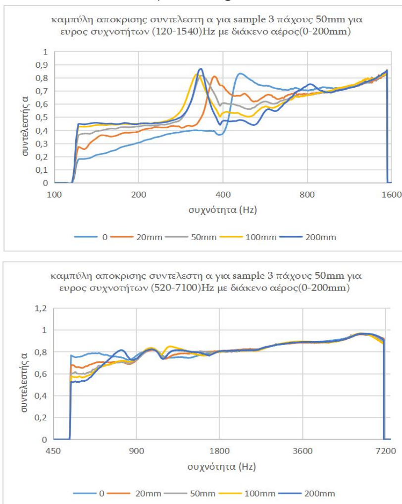
Εικόνα 85: Σύγκριση του συντελεστή απορρόφησης \alpha για το sample 3 πάχους 50 mm και διάκενο αέρος 0 – 200 mm. Πάνω διάγραμμα εύρος συχνοτήτων 120 Hz – 1540 Hz κάτω διάγραμμα εύρος συχνοτήτων 520 Hz – 7100 Hz.
