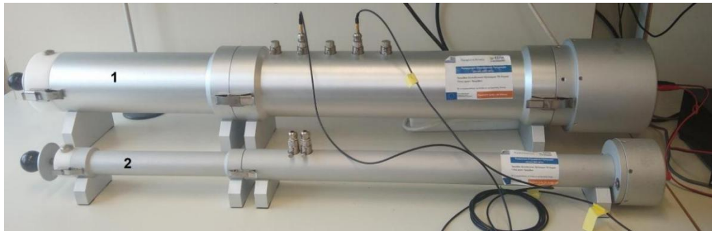
Εικόνα 24: Διάταξη σωλήνων Kundt για μέτρηση συντελεστή \alpha , σωλήνας 1, 100 mm διάμετρος, σωλήνας 2, 28 mm διάμετρος.
